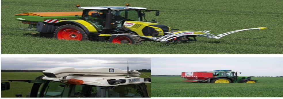
Şekil 6. Alana özgü sensör tabanlı gübrelemede kullanılan LED'li (üstte), aktif ve pasif 3 teknolojik sistem
