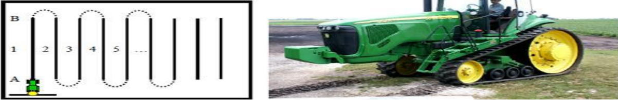
Şekil 5. AB hattı ve sonsuz (gösterilmeyen) paralel izler ve Auto Trac direksiyon sistemi kullanan bir John Deere traktörü.
