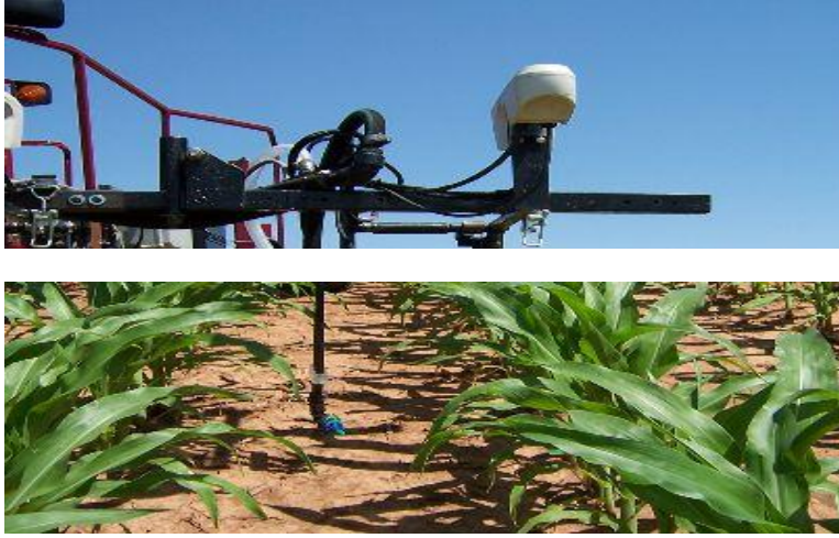
Şekil 3. İlaçlamada sensör tabanlı değişken oranlı ilaç uygulama sistemi.
